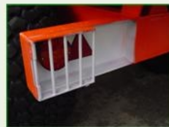
Éclairage poids lourd, avec protections
